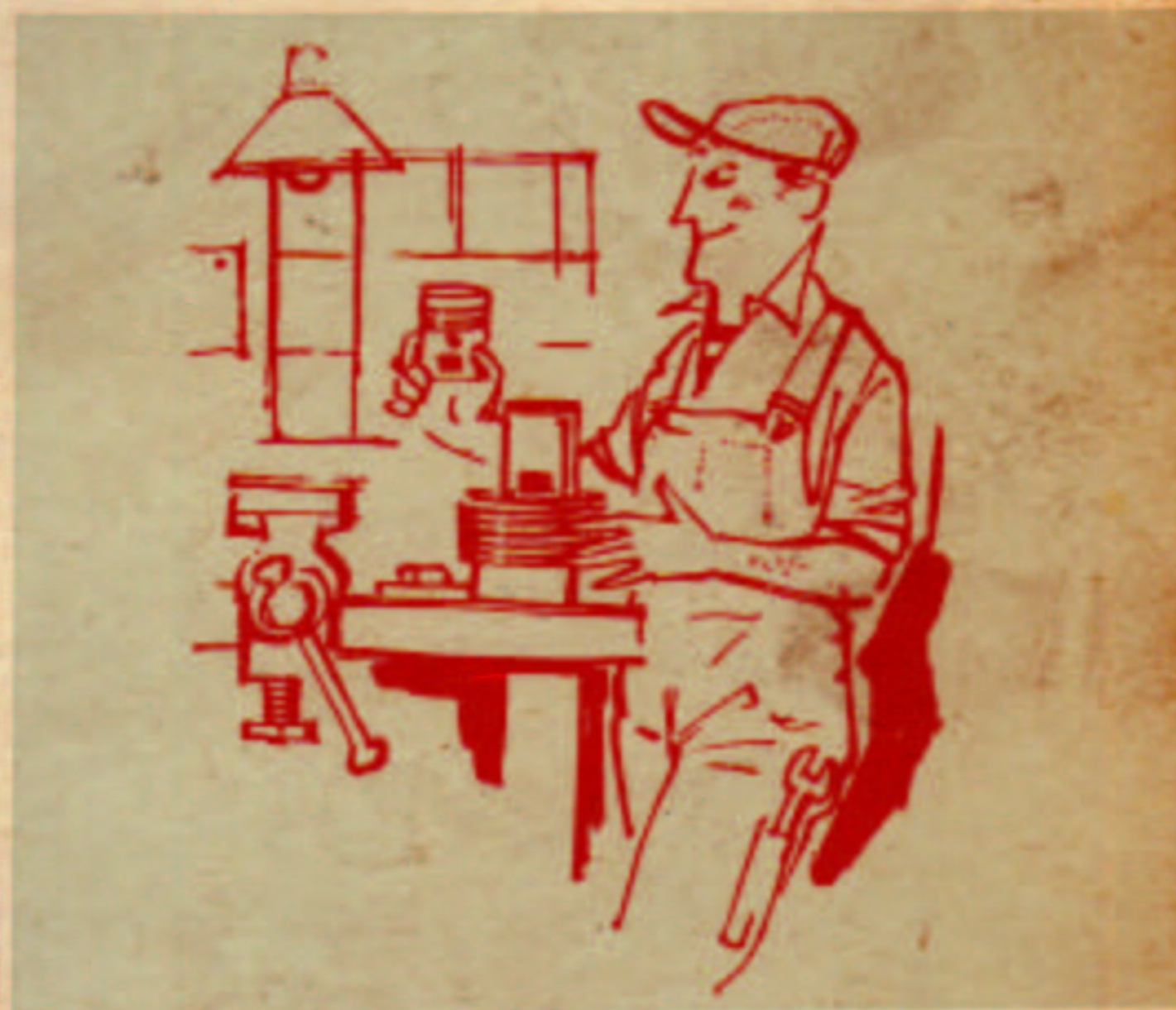
Abb. 17 – Auspressen der Pleuelstangenbüchse Fig. 17 – Removing the small end bush
